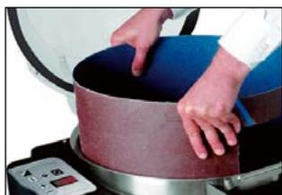
Paredes abrasivas de fácil reemplazo
