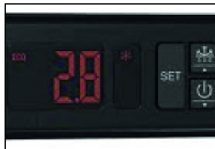
Control de temperatura mediante termostato electrónico digital.
