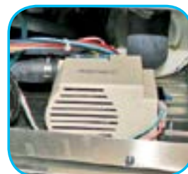
Bomba de descarga
