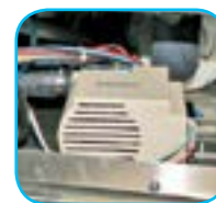
Bomba de descarga
