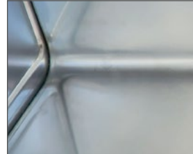
Cantos redondeados para reducir la acumulación de suciedad.
