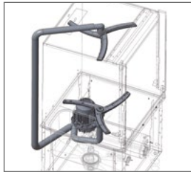
Bomba de doble flujo.
