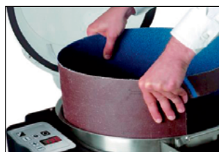
Paredes abrasivas de fácil reemplazo
