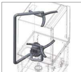
Bomba de doble flujo.
