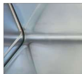
Cantos internos redondeados para facilitar limpieza
