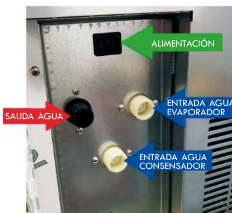
Doble conexión hidráulica en máquinas refrigeradas por agua (de ECP37a ECP100) PARA TRATAR EL AGUA DE FABRICACION
