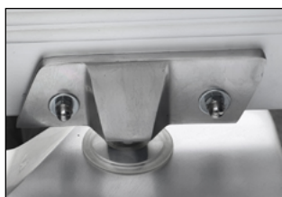
Posibilidad de ajuste plato cuchilla
