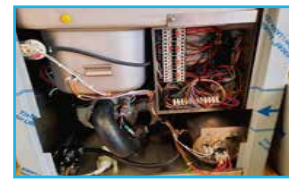
2 Bombas de lavado: 1HP independientes para brazo superior e inferior, máximo rendimiento y fácil accesibilidad.
