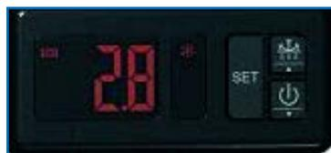
Control de temperatura mediante termostato electrónico digital con lectura constante y posibilidad de desescarche
