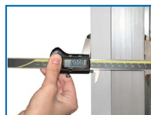
Aislamiento ecológico con 80 mm de espesor
